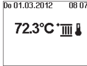
Festwertregelung Isttemperatur = Vorlauftemperatur
