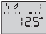
Hand-Sollwert (angezeigt wird der aktuelle Drehwinkel)
