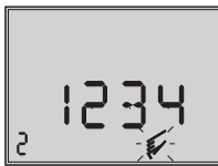
Leserichtung für Anbau pneumatische Anschlüsse links
